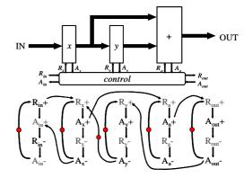
Fig. 11. Bundled-Data Filter Controller
